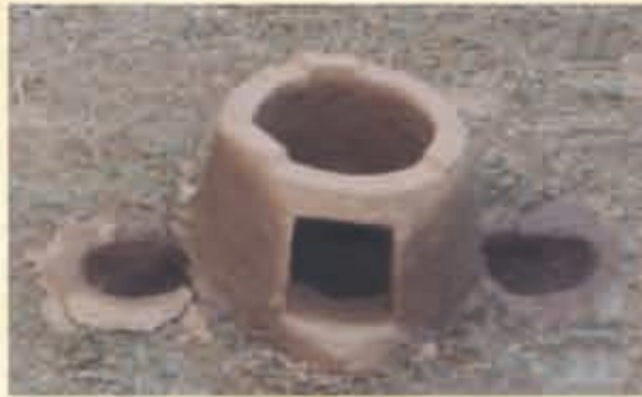
চিত্র নম্বর- ২: চিমনীবিহীন একমুখী উন্নত চুলা (অর্ধেক মাটির নিচে)
